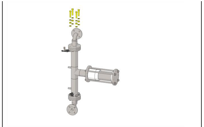
Fig. 3.6.5a Lösen und entfernen Sie acht Sechskantschrauben [38], die den Druckstutzen [3] mit den Gehäusen [1] verbinden.
